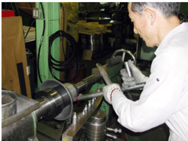
ヘラ絞り加工の現場
